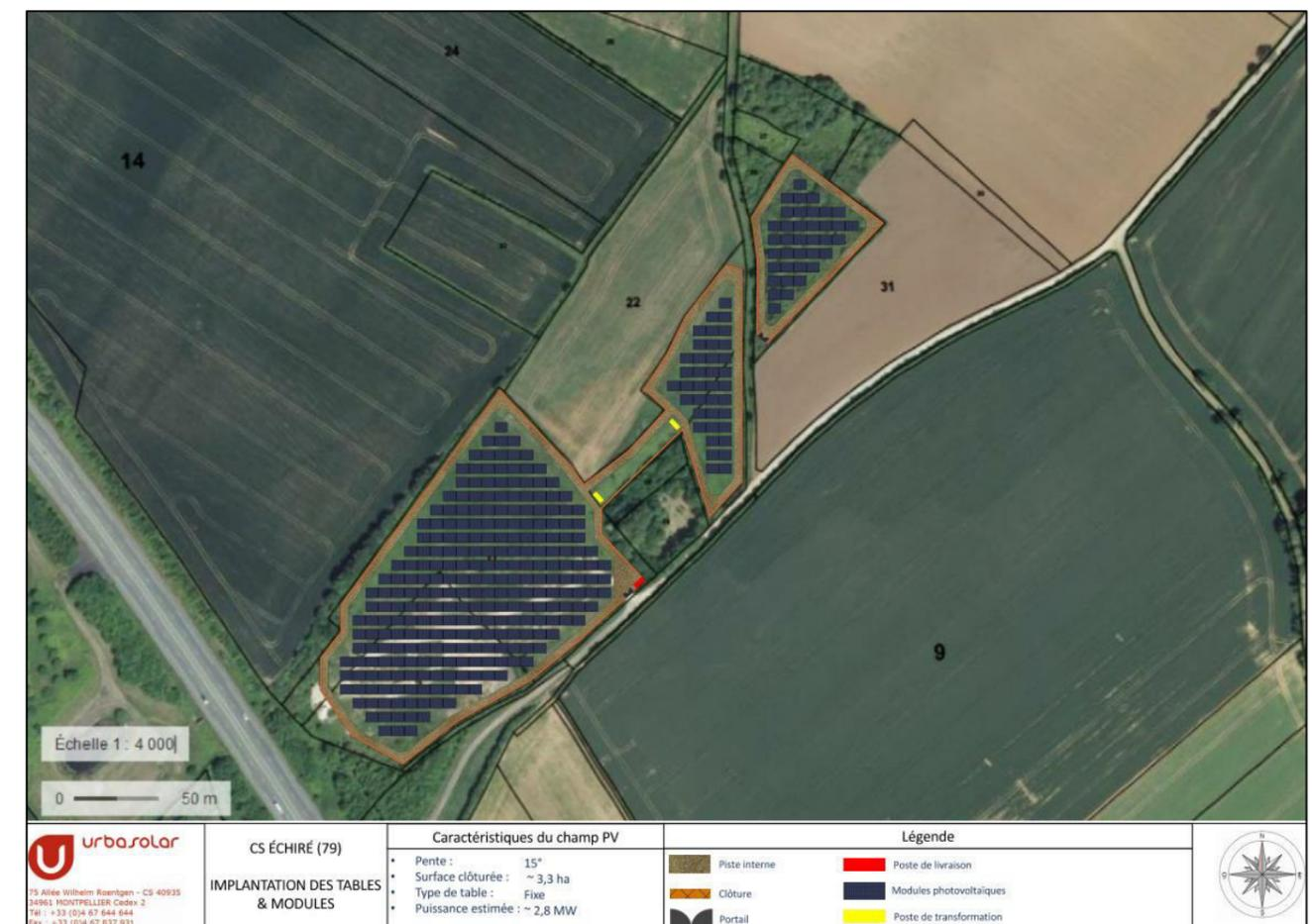
Figure 181 : Présentation de la variante 1 du projet de centrale photovoltaïque au sol d'Echiré
